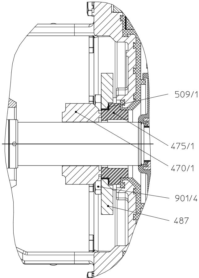
Alternativ: Dichtungseinheit **478/1**, bestehend aus rotierender Einheit **470/1** und Gegenring **475/1**
